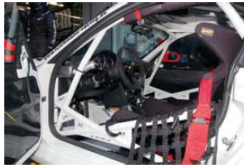
Ein Hauch von DTM-Flair: Anscheinend orientierte sich der Bonner Käfigproduzent Martin Scheel an der A-Säulen-Abstützung des Audi A4
